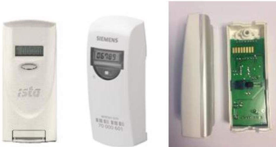
Slika 2: Razdjelnici troškova toplinske energije
